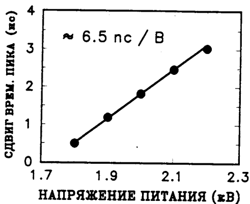
Рис.13. Характерная зависимость сдвига среднего значения временного спектра от приложенного высокого напряжения
